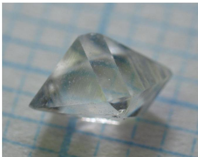
*Монокристалл титанил фосфата калия  $KTiOPO_4$ , сегнетоэлектрик и нелинейный оптический кристалл.*
