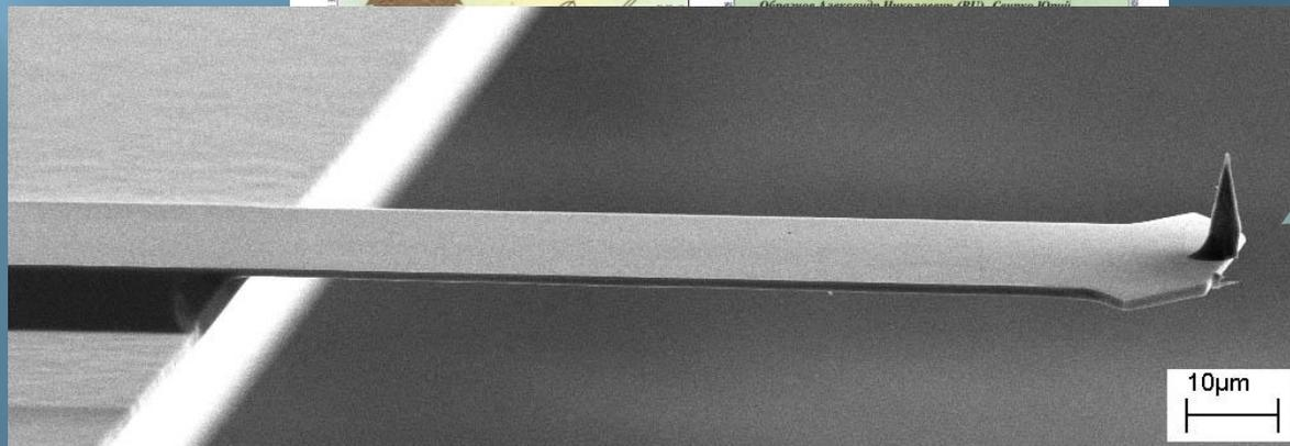
Алмазная нано-игла, закрепленная на кантилере зондового микроскопа.
