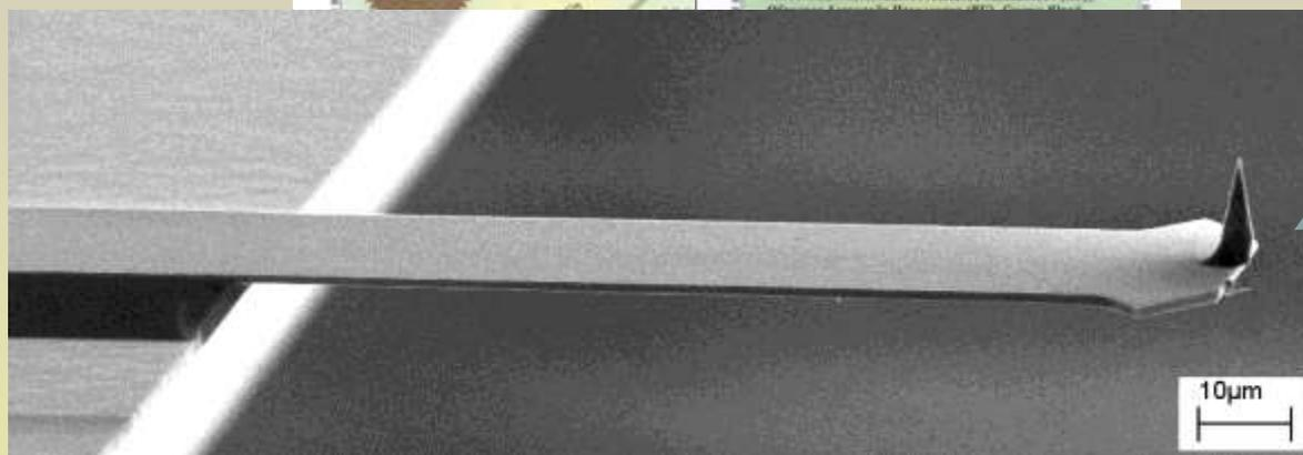
Алмазная нано-игла, закрепленная на кантилере зондового микроскопа.
