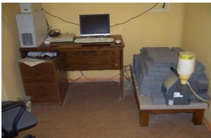
Рис.5 установка измерения  $\gamma$ -спектров
