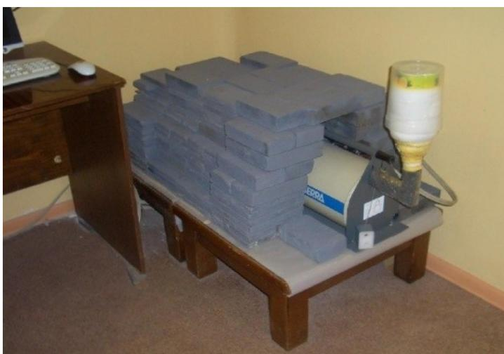
Рис.6 HPGe детектор  $\gamma$ -квантов в свинцовой защите
