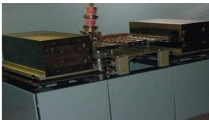
Рис 3. Разрезной микротрон импульсного действия с максимальной энергией пучка 70 МэВ
